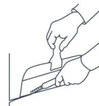
Verarbeitung an Außenkanten: Mit feinem Nassschleifpapier (≥ P 240) das Produkt an der Kante leicht anschleifen (nicht durchschleifen!), um die Außenkante legen und blasenfrei andrücken.
